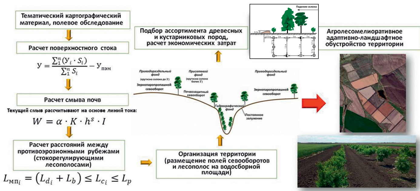
Рис. 5. Технология создания систем управления эрозионно-гидрологическим процессом и разработки адаптивно-ландшафтных систем земледелия
