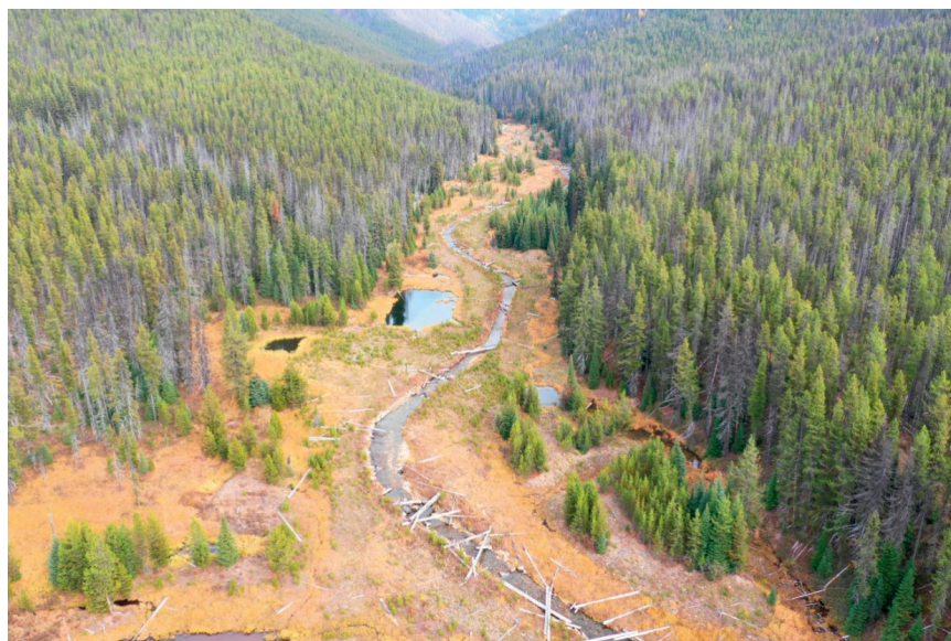
Рис. 2. Выположенная долина р. Шерлок (США) на участке россыпной добычи золота после рекультивации. На снимке видны стволы деревьев на пойме — искусственно распространенные для снижения возможной эрозии и как источники поступления органического вещества в пойменную экосистему (фото автора, 12.10.2018)
