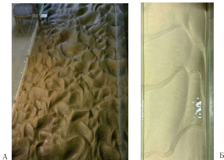
Рис. 1. Грядовое движение донных наносов в первом и в четвертом экспериментах:
