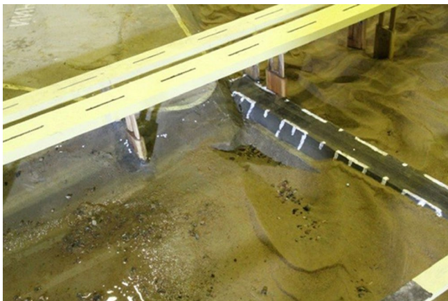
Рис. 6. Яма размыва в нижнем и верхнем бьефах продольной запруды после прохождения максимального расхода воды Q = 3500 \text{ м}^3/\text{с}
